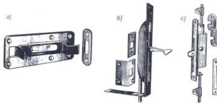
Rys. 18.2. Zasuwy i zasuwnice: a) zasuwa wierzchnia, b) zasuwa wpuszczana czołowa z dźwignią, c) zasuwica wpuszczana czołowa bez trzpienia [5,s.293]
