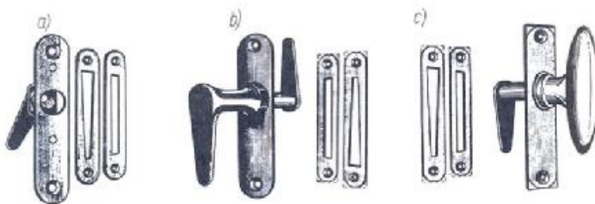
Rys. 18.3. Zakrętki: a) wpuszczana kluczowa, b) wpuszczana jednoramienna, c) wpuszczana dwuramienna[5,s.293]
