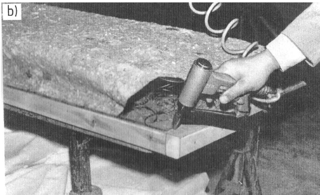
Rys. 20. Mocowanie tkaniny jutowej do ramy a) za pomocą gwoździ tapicerskich, b) zszywkami [3, s.118]
