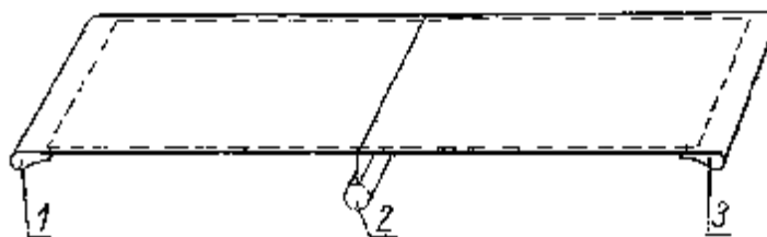
Rys. 2. Warstwa nośna siedzenia z kołdry tapicerskiej, 1 – zakładka siedzeniowa przednia, 2 – zakładka siedzeniowa tylna, 3 – zakładka oparciowa [2, s. 191]
