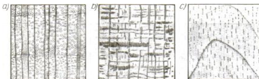
Rys. 10. Schematyczny rysunek przekrojów drewna buka zwyczajnego: a) przekrój poprzeczny pod mikroskopem, b) przekrój promieniowy, c) przekrój styczny [11, s. 78]
