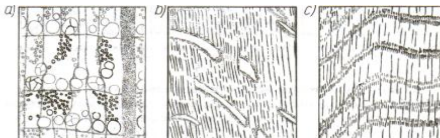
Rys. 9. Schematyczny rysunek przekrojów drewna dębu szypułkowego i bezszypułkowego: a) przekrój poprzeczny, b) przekrój promieniowy pod mikroskopem, c) przekrój styczny [11, s. 77]
