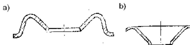
Rys. 34. Ozdobne podkładki tapicerskie (przekroje): a) do płatów pokrytych folią, b) do twardych płatów płyty pilśniowej lub tworzywa sztucznego [5, s. 197]
