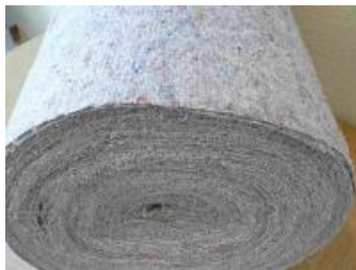
Rys. 38. Włóknina WSP 12 o przeszyciu trykotowym [32]
