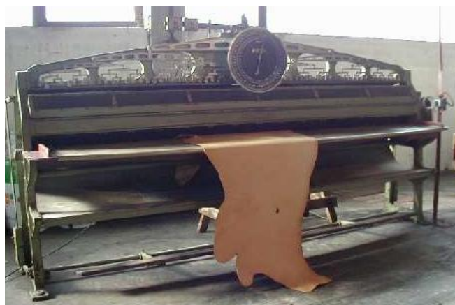
Rys. 6. Urządzenia do mechanicznego pomiaru powierzchni skóry a) Planimetr [19] b) Maszyna mechaniczna do mierzenia powierzchni skór [26]
