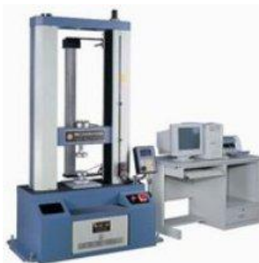
Rys. 9. Maszyna wytrzymałościowa [29]Badanie wytrzymałości na rozciąganie i wydłużenia procentowego przeprowadza się według normy PN – EN ISO 3376: 2005
