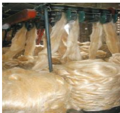
Rys. 20. Włókno sizalu podczas produkcji lin [109].
