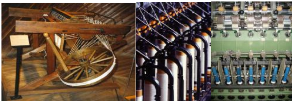
Rys. 50. Urządzenia do przędzenia a) pierwsza przędzarka b) niedoprzędzarka skrzydełkowa c) przędzarka obrączkowa[29]
